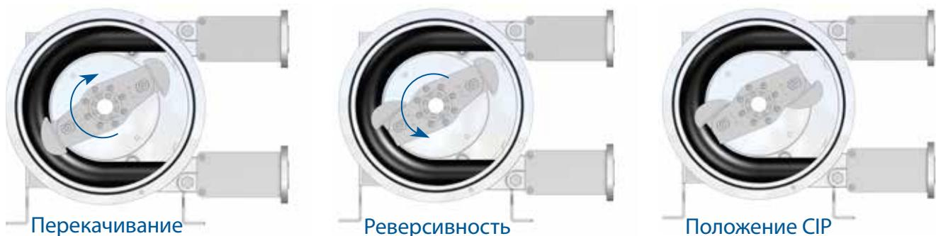
Насосы PT доступны в варианте «CIP wheel» (Clean In Place). Это позволяет пользователям, просто меняя направление вращения насоса ( $\frac{1}{2}$  оборота), иметь возможность автоматически втягивать башмаки для выполнения очистки и операции стерилизации, без каких-либо действий на насосе. Клиент экономит время и сохраняет высочайший уровень функциональности в процессе.
