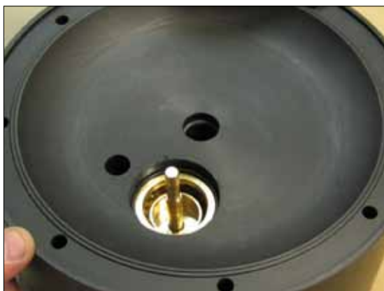
Рис 5.16. Теперь, когда оба края свободны, снимите вал и поршень.
