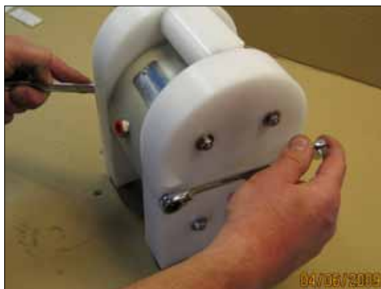
Рис 6.24. Установите всасывающий\нагнетательный патрубки (13), проверьте, чтобы все уплотнительные кольца (18) были установлены.
