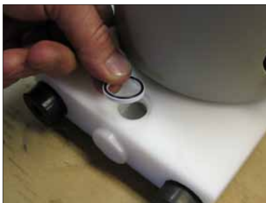
Рис 6.23. Вставьте маленькое уплотнительное кольцо (поз 18) в седло корпуса. Для насосов с мембранами PTFE (серийный номер 1105 ... и старше) уплотнительное кольцо должно быть установлено с родным уплотнительным кольцом наверх.
