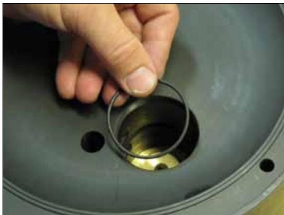
Рис 6.5. Поместите одно из уплотнительных колец (поз 30) на торцевую крышку.
