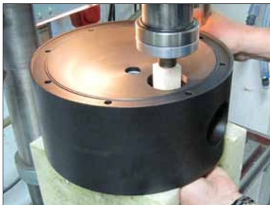
Рис 5.18. Осторожно отожмите цилиндр, не повредив его края.
