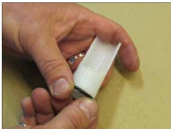
Рис 6.15. Поместите шарик клапана (23) в нижнее седло клапана (21) и поставьте стопор шарика (22). Поставьте уплотнительное кольцо седла клапана (43) в нижнее седло (21)
