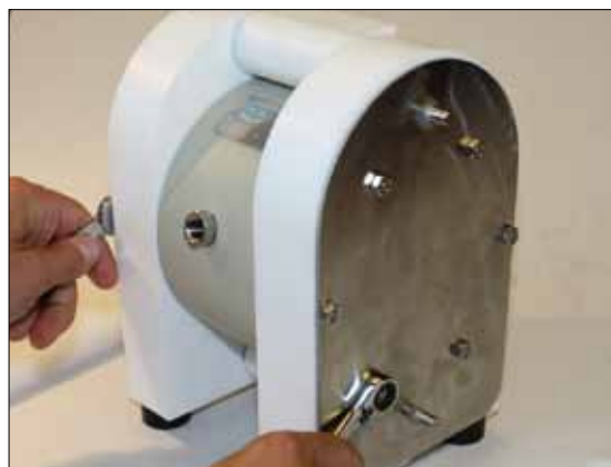
Рис 5.2. Открутите корпусные гайки (37). Аккуратно вытащите шпильки (14). Положите насос на ту сторону, на которой остались гайки на прочное основание. Осторожно отсоедините «отвинченный» корпус.
