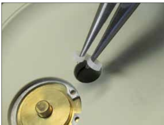
Рис 6.12. Для установки уплотнения вала (36), согните его в почкообразную форму и осторожно вставьте в паз.
