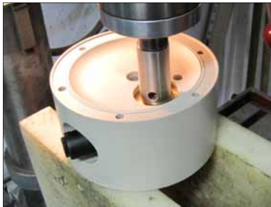
Рис 5.14. Отожмите воздушный клапан (61) с помощью отжимного прибора. Будьте аккуратны, чтобы не повредить медные края воздушного клапана.
