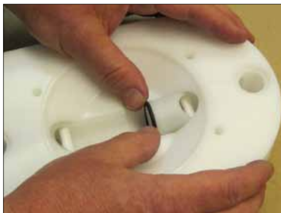
Рис 6.17. Поместите комплект верхнего седла; верхнее седло (20), шарик клапана (23), стопор шарика (22) и о-ринг (43).
