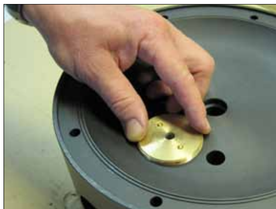
Рис 6.3. Тщательно закрутите торцевую крышку вручную в центроблок. Иногда вначале необходимо повернуть крышку по часовой стрелке пока резьба не зафиксируется.
