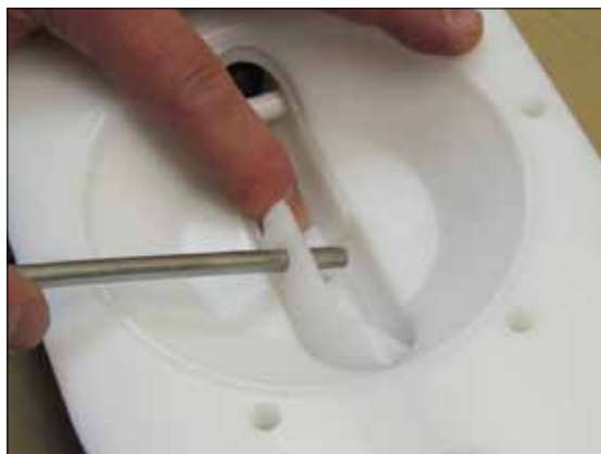
Рис 6.19. Вставьте один из контактных винтов в отверстие прокладки рукава (19) и аккуратно его проверните.
