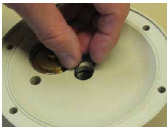
Рис 6.11. Вставьте уплотнительные кольца вала (47) в отверстие.
