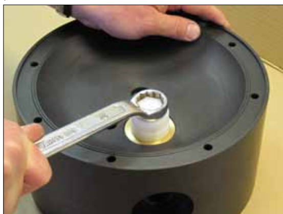
Рис 5.15. Аккуратно открутите край воздушного клапана с помощью монтажного инструмента (282). Прodelайте ту же операцию с другого края.
