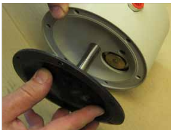
Рис 6.14. Установите вал мембраны (16) в мембрану (15) и аккуратно втолкните сборку через отверстие в центроблоке (12).
