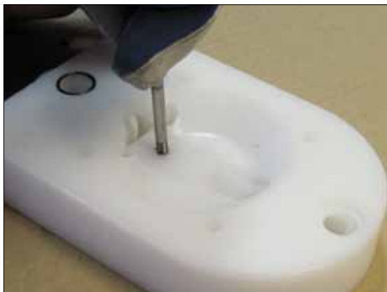
Рис 5.9. Закрутите винт в отверстие распорной втулки (19). В новых моделях TR9 такого отверстия не предусмотрено, поэтому поднимите распорную втулку без использования винта.
