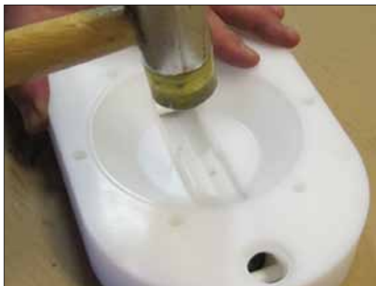
Рис 6.20. Убедитесь, что сборка седла и рукава беспрепятственно входят внутрь корпуса.
