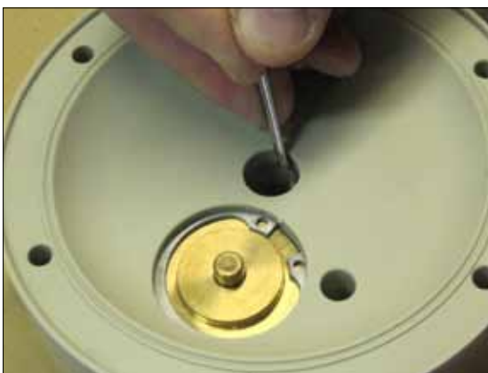
Рис 5.12. Если уплотнения вала (36) изношены (из-за внутренних утечек воздуха), аккуратно удалите их острым инструментом. Во время этой операции возможно повреждение уплотнений (36) и запасного уплотнительного кольца (47), поэтому убедитесь в наличии запасных частей и возможности замены поврежденных уплотнений.
