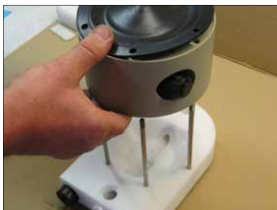
Рис 6.22. Убедитесь, что все болты (14) имеют по одной шпильке (37) и одной шайбе (38) каждый. Шпилька устанавливается на одну или две резьбы. Аккуратно вставьте болты через корпус и установите центроблок.
