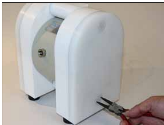
Рис 5.1. Открутите заглушки (571) плоскогубцами. Аккуратно снимите боковые крышки PE (1181).
