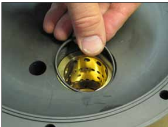
Рис 6.7. Поместите оставшееся уплотнительное кольцо (поз 30) на цилиндр.
