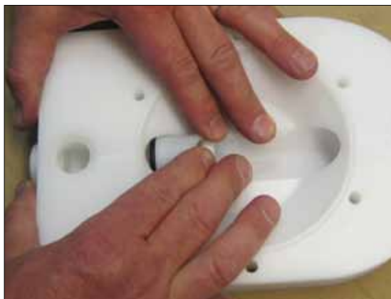
Рис 6.16. Втолкните сборку нижнего седла клапана в корпус (11)
