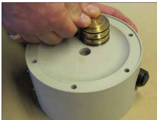
Рис 6.2. Капните немного воды на уплотнительные кольца (30), прочие смазочные материалы не должны использоваться. Аккуратно задвиньте воздушный клапан (61) в корпус. Установите стопорное кольцо (27) на вторую сторону (см. рис. 6.1).
