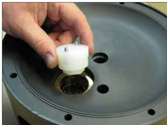
Рис 5.17. Чтобы вытолкнуть цилиндр, используйте другую сторону монтажного инструмента, расположенного в цилиндре.
