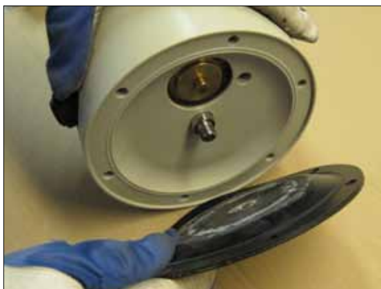
Рис 5.11. Поставьте мембраны (15) в их нейтральное положение (обе мембраны находятся на одинаковом расстоянии от центрального блока). Удерживая одну из мембран (15), открутите другую. Затем снимите оставшуюся мембрану (15) с мембранного вала (16).
