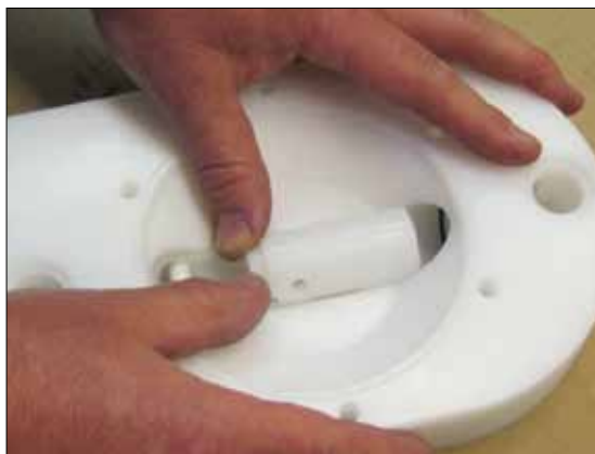
Рис 6.18. Поместите распорную втулку (19) вверх ногами и зажмите ее в верхнем седле клапана (20).
