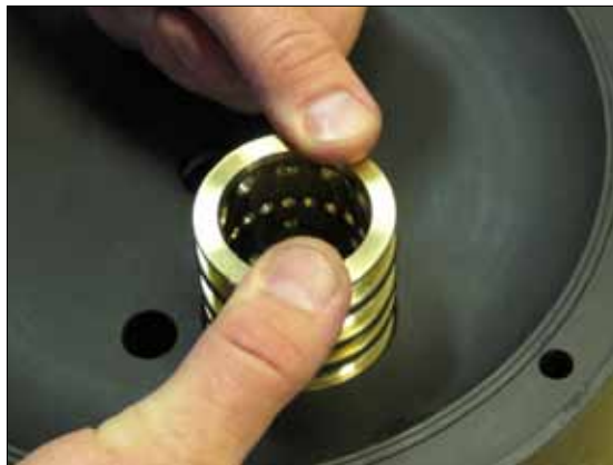
Рис 6.6. Убедитесь, что все четыре уплотнительных кольца (поз 30) установлены на цилиндре. Используйте немного воды на уплотнительных кольцах для лучшего скольжения цилиндра в центроблоке. Другие смазочные вещества не должны использоваться.
