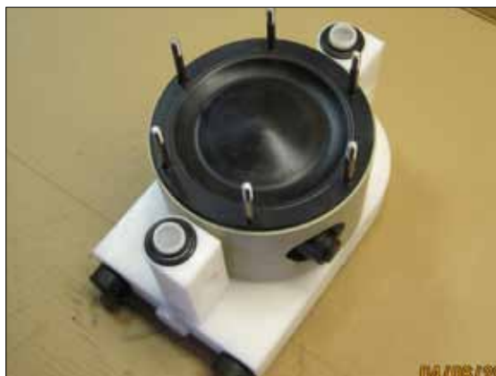
Рис 6.24. Установите всасывающий\нагнетательный патрубки (13), проверьте, чтобы все уплотнительные кольца (18) были установлены.
