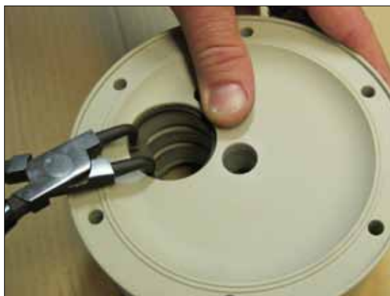
Рис 6.1. Поднимите стопорное кольцо (27) с одной стороны.
