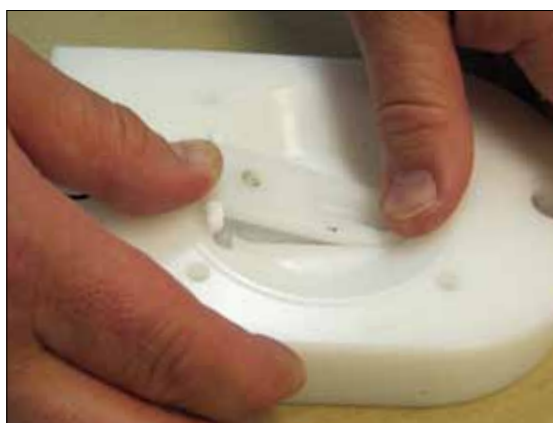
Рис 6.21. Сначала вставьте нижний (21) и верхний (20) штоки клапана. Вставьте прокладку рукава (19) с помощью штифта (22) в корпус (11). Возможно, вам придется постучать аккуратно пластмассовым молотком.
