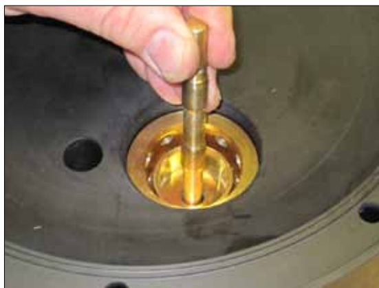
Рис 6.8. Осторожно закрепите поршень и вал вручную. Повторите действия, изображенные на рис. 6.3 и 6.4. Тщательно закрепите заглушки с обеих сторон.
