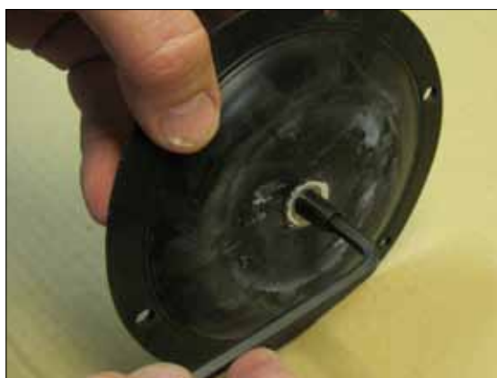
Рис 6.13. Установите контактный винт (часть вала мембраны) (поз 16) надежно в мембрану (15) с помощью шестигранного ключа.
