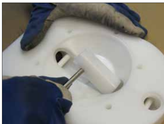
Рис 5.6. Осторожно извлеките распорную втулку (19). Обратите внимание на то, что данная операция не требует применения силы.
