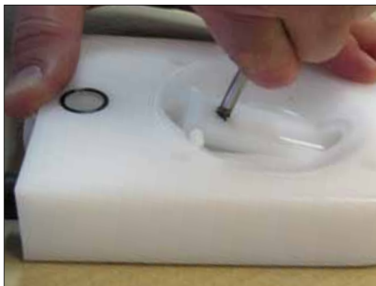
Рис 5.10. Поднимите и опустите распорную втулку (19).
