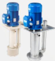
СТВ - бессальниковый насос с допустимым сухим ходом, предназначенный для перекачивания и циркуляции различных жидкостей из контейнеров, отстойников и резервуаров. Он изготовлен из PP (полипропилена), PVDF или нержавеющей стали AISI 316L.
