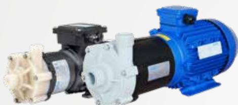
СТМ - компактный насос без уплотнения, где мощность от двигателя передается на импеллер с помощью магнитной муфты. Компонентами, контактирующими с жидкостью, являются неметаллические термoplastы из полипропилена PP-GF или PVDF. Насосы перекачивают многие типы жидкостей с низкой вязкостью, такие как химически агрессивные и токсичные.
