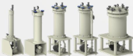
Картриджные фильтры с 1, 3 или 7 картриджами являются автономными устройствами, оснащенными насосом СТМ или в сочетании с вертикальным насосом СТВ. Картриджи доступны с ячейками 1, 10, 20 и 50 мкм, обеспечивая эффективность фильтрации до 95%. Серия FT доступна в PP.
