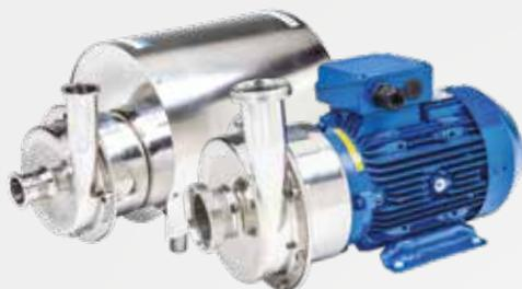
Это одноступенчатые центробежные насосы с открытым или полуоткрытым импеллером, изготовленные из высококачественной нержавеющей стали AISI 316L. Корпус промышленной серии СТИ подвергается пескоструйной обработке. Доступны различные варианты механического уплотнения и специальные исполнения для удовлетворения большинства типов промышленных задач.
