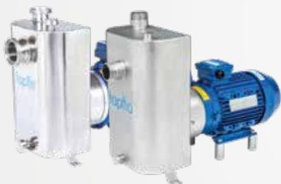
Функция самовсасывания позволяет использовать насос в тех случаях, когда стандартные насосы СТ не могут справиться с задачей. Насос СТС способен создавать всасывание на высоту до 4,5 м. Заменяя только один элемент - корпус с самовсасывающей камерой, мы можем добиться различных преимуществ для нашего насоса. Теперь насос может всасывать жидкость с более низкого уровня, чем он расположен, или перекачивать жидкости с высоким содержанием воздуха.
