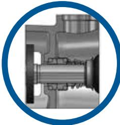
В стандартном исполнении комплектуются одинарными механическими уплотнениями. Уплотнение расположено внутри корпуса насоса. Это решение обеспечивает максимальный теплообмен между поверхностью уплотнения и перекачиваемой продукцией, что способствует повышению долговечности насоса.
